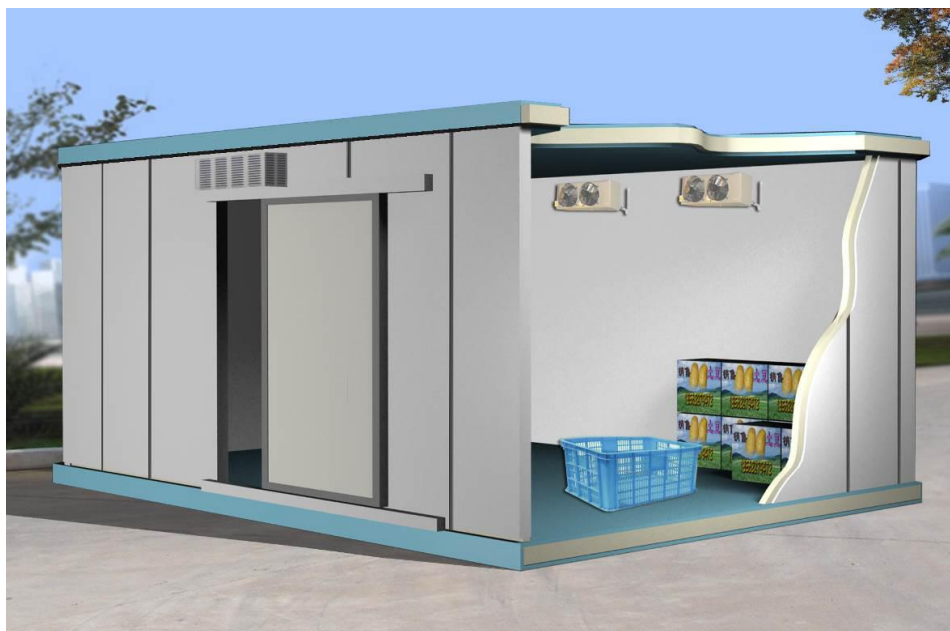
图 2-4 组装式高温库示意图
